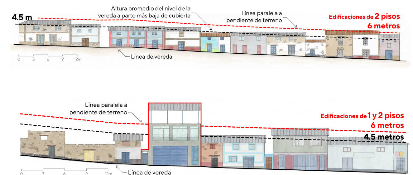
ILUSTRACIÓN 23. Elevación de manzana 23 de Cabana. La elevación evidencia cómo la nueva forma de construir una terraza techada rompe la escala de la manzana. Fuente: Archivo de Equipo ATS
